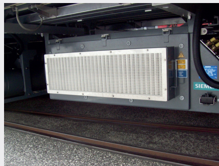
AUSBLASGITTER IM UNTERFLURBEREICH
